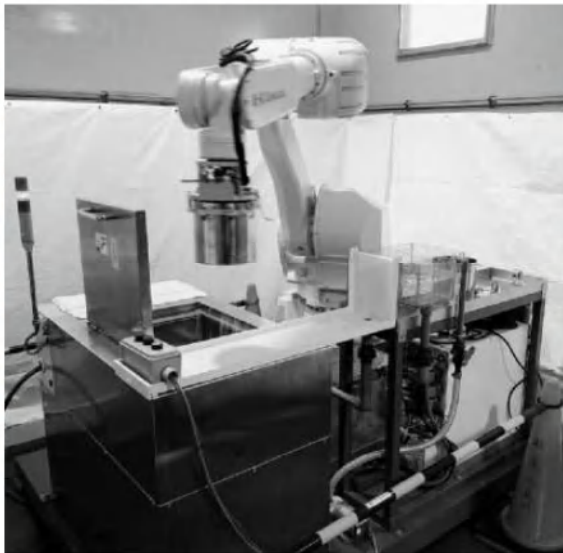
島谷技研が構築した吸引乾燥装置への産ロボ連動による自動化システム
